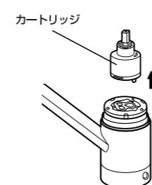
ご注意: カートリッジは樹脂製の精密部品です。破損・落下はしないようにしてください。
